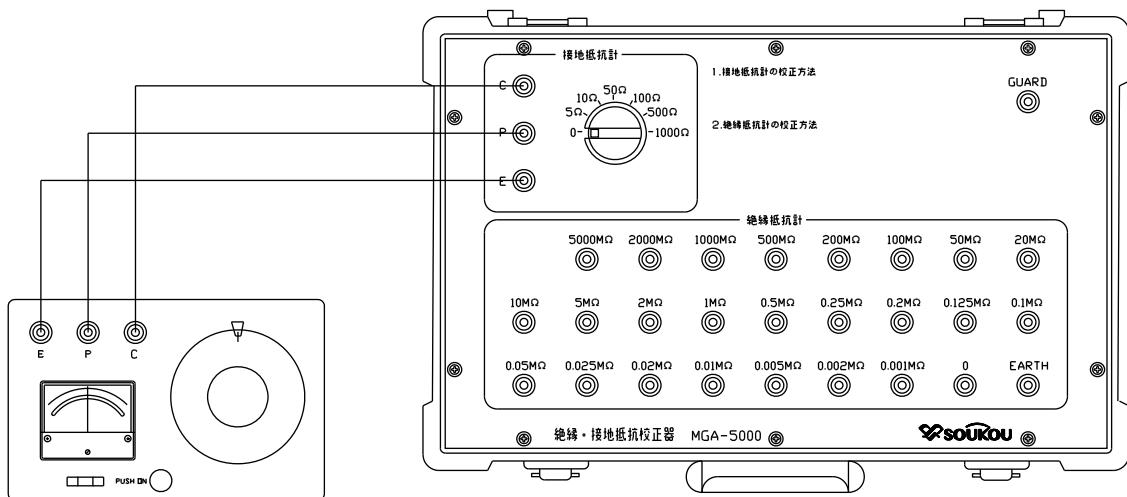
・絶縁抵抗計の校正接続図（ガードを接続しない場合）【図2】
