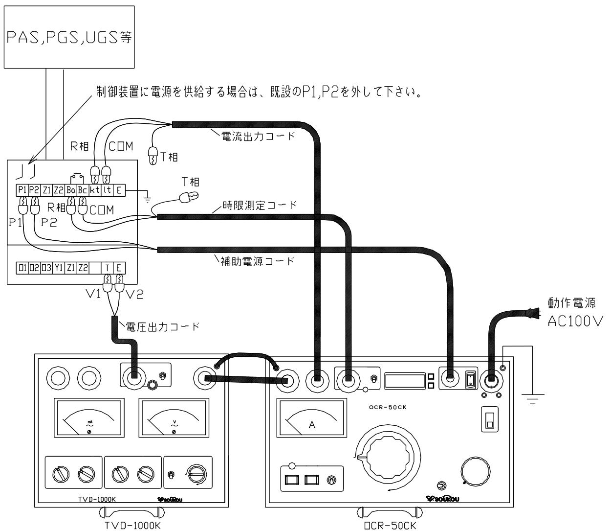
図3：試験回路図一柱上の単体試験（停電状態）
